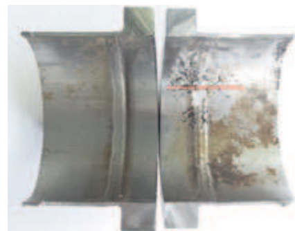
▲ Figuur 3: Macroscopisch beeld van gefaalde zone (zijde aangezuurd product / CIP). De rode lijn duidt de positie aan van metallografisch onderzoek.
