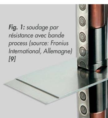
Fig. 1: soudage par résistance avec bande process (source: Fronius International, Allemagne) [9]
