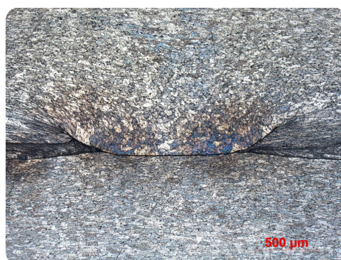
Figure 7: détail de la figure 5: 'bonding ligament'
