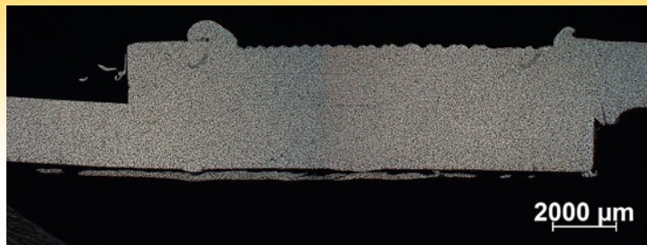
Fig. 10: soudage par points à ultrasons de l'alu sur l'alu (source: Riftec GmbH, All.)
