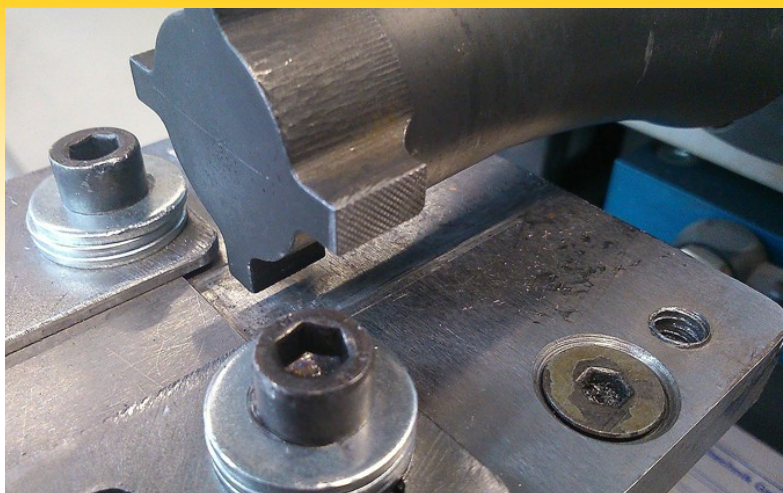
Figure 9: sonotrode dans le soudage par points à ultrasons (source: Institut Belge de la Soudure)
