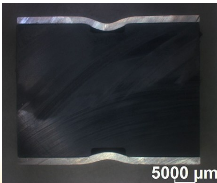
Figure 13: assemblage entre une barre composite et un tube en alu (source: Institut Belge de la Soudure)
