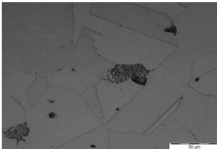
Figure 2: phase à faible point de fusion (vue par microscope optique)
