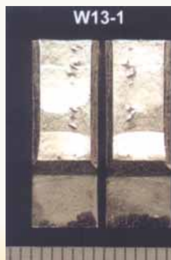
Figure 5: Surface de rupture d'une éprouvette CTOD. L'entaille se trouve en-dessous. L'extrémité de la fissure de fatigue (partie plus claire) n'est pas droite mais quelque peu courbe
