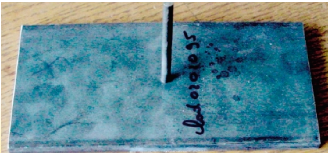
Figure 6: tôle avec barre pour essai de traction
