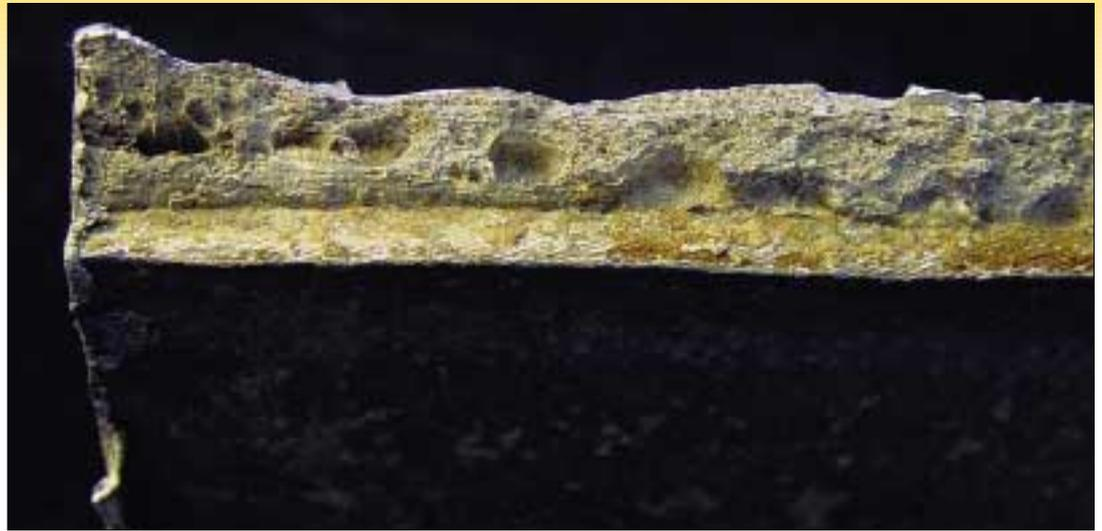
Fig. 2: Exemple d'une soudure poreuse
