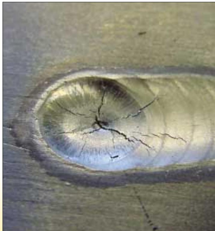
Fig. 7: Exemple d'une fissure de cratère typique
