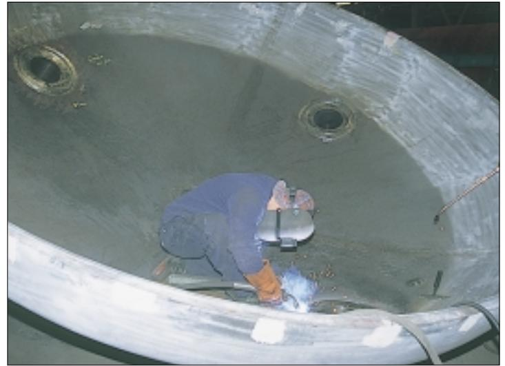
*Un conseil pour éviter les fissures induites par l'hydrogène: utilisez des procédés de soudage à faible teneur en hydrogène*
