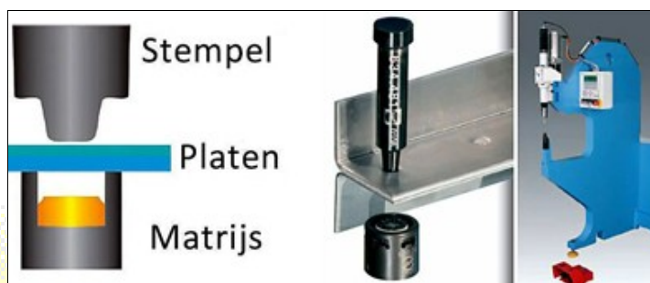
Figuur 1 (boven): Uitvoering van een clinchpers (bron: Kaho Sint-Lieven)
