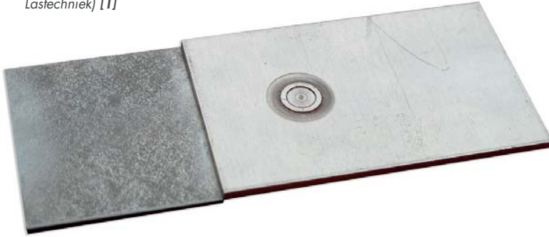
Fig. 9: lasverbinding tussen een aluminium (EN AW-6082) en gegalvaniseerde stalen (MS-W1200+ZE50/50) plaat via wrijvingspuntlassen (bron: Belgisch Instituut voor Lastechniek) [1]
