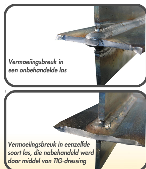
Figuur 1: de nabehandelde las behaalde een hogere levensduur bij een vermoeiingsproef
