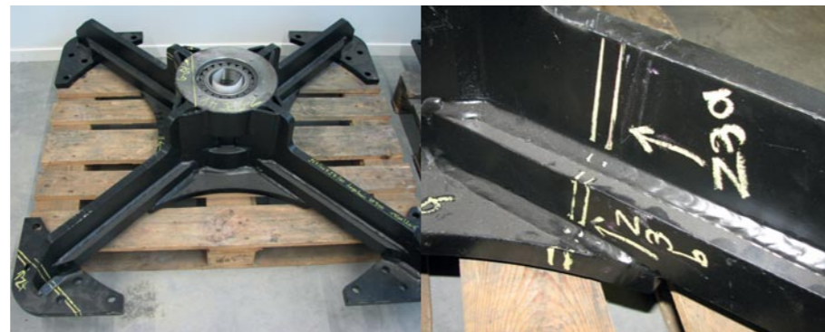
Figuur 7 HF900 lagerhuis. Links het oorspronkelijk ontwerp en rechts een detail met de meest kritische las ter hoogte van de stervormige versteviging.
