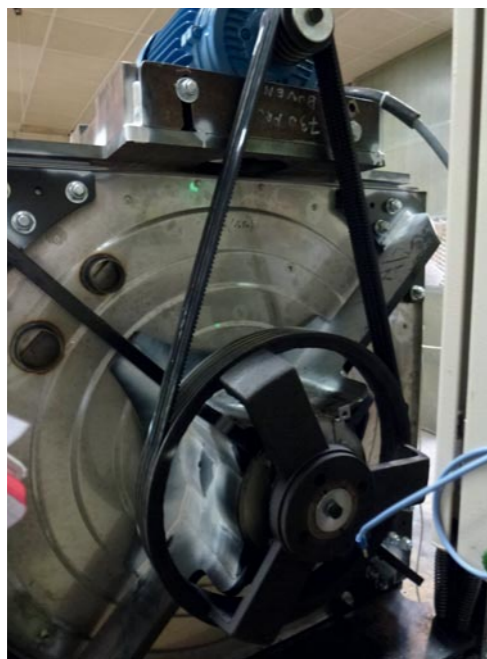
Figuur 6 HF900 lagerhuis klaar voor de out-of-balance-test
