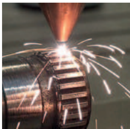
▲ Figuur 4: Additive manufacturing met een systeem voor laser cladden laat toe een prototype van een tandwiel op te bouwen in 3 uur (fig LCV)
