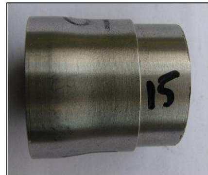
Figuur 28 : Afsluiten van een roestvast stalen buis met een roestvast stalen eindstuk
