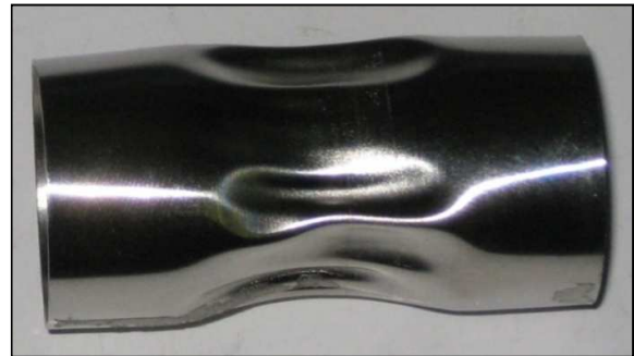
Figuur 16 : Resultaat van een vrije vervorming, gebruik makend van een aluminium tapevormig driver materiaal (wanddikte : 1 mm). Wanddikte van de roestvast stalen buis : 0,4 mm
