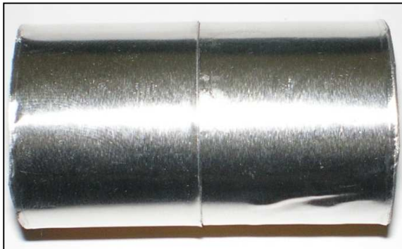
Figuur 15 : Gebruik van een tapevormig driver materiaal (aluminium tape driver, wanddikte : 1 mm), wanddikte van de roestvast stalen buis : 0,4 mm
