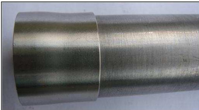
Figuur 27 : Afsluiten van een koolstof stalen buis met een roestvast stalen eindstuk
