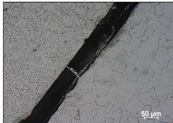
Figuur 30 : Detail van Figuur 29 (maximale spleetbreedte : 90 μm)
