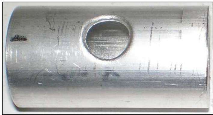
Figuur 5 : Resultaat van experiment P_Al_04 (voltage = 11,0 kV - 9,7 kJ)
