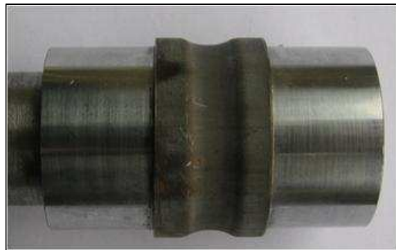
Figuur 24 : Gekrompen ring op een gechromeerde stalen staaf (geprofileerd inwendig werkstuk)
