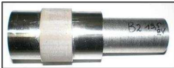
Figuur 23 : Gekrompen ring op een gechromeerde stalen staaf (geen profilering van het inwendig werkstuk)
