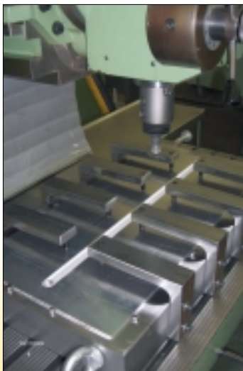
Figuur 3: Het friction stir welding proces in werking in het kader van project ALUWELD (bron: UCL-PRM)
