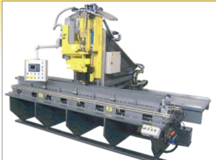
Figuur 2: De grote ESAB friction stir welding machine die begin 2006 operationeel zal zijn bij CEWAC (bron: ESAB)
