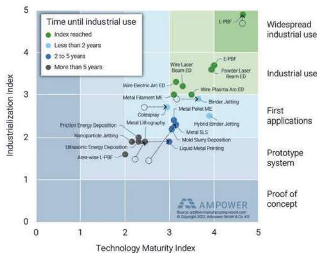
Abbildung 1. Reifegradindex metallbasierter additiver Fertigungstechnologien 2022 (AMPOWER)
