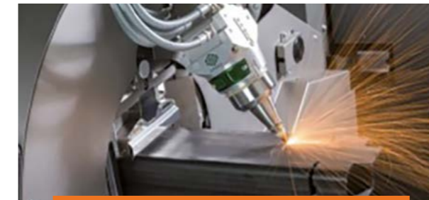
Découpe au laser de profilés tubulaires
