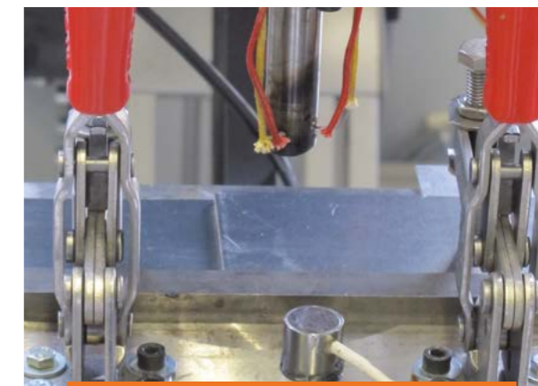
Laskop van het wrijvingspuntlastoestel met sensoren voor akoestische emissie monitoring Onderzoek
