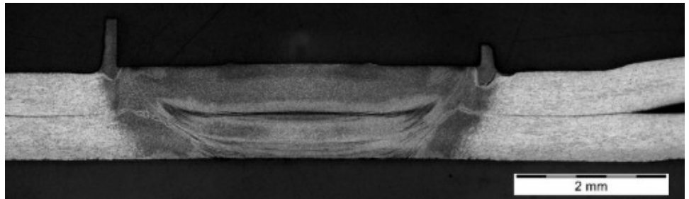
Figure 4: Exemple d'une soudure d'AA7075-T6, avec joint adhésif (décapée)
