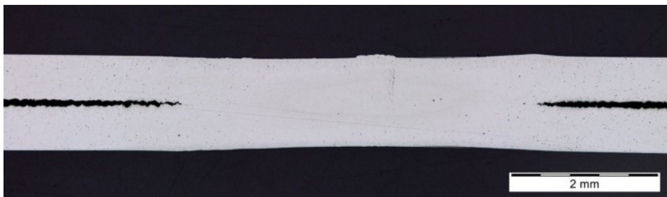
Figure 7: Section d'un échantillon soudé – plaquettes nettoyées au laser (EN AW-7075-T6)
