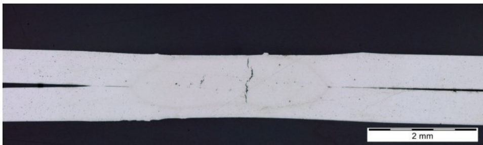
Figure 6: Section d'un échantillon soudé – plaquettes non traitées (EN AW-7075-T6)
