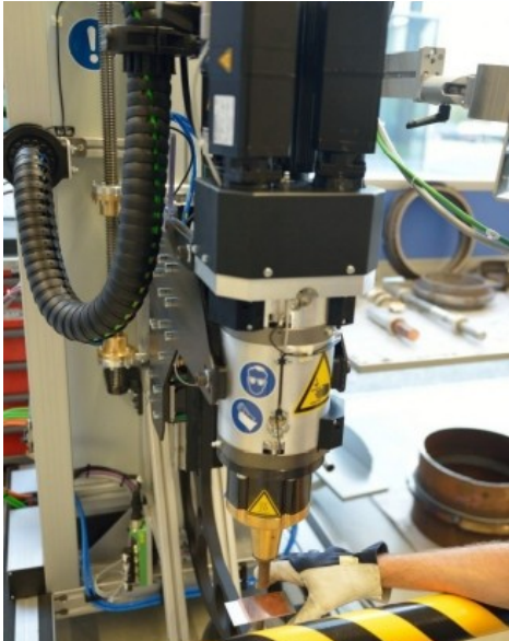
Figure 2: Machine de soudage par points par friction à l'Institut belge de la Soudure (I.B.S.)
