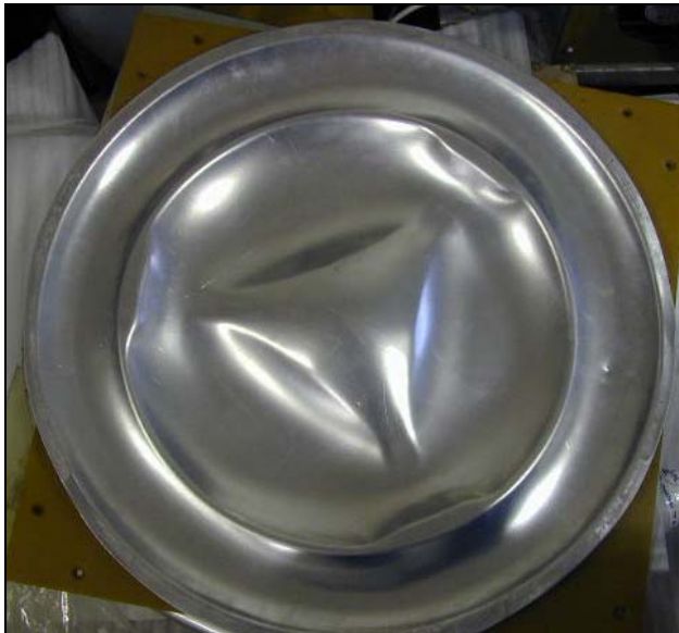
Figuur 21 : Magnetisch puls vormen – Roestvast staal, diameter 300 mm [5]
