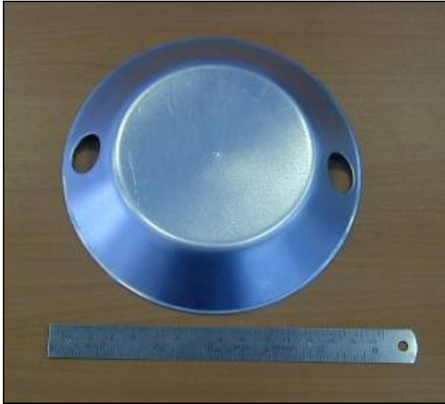
Figuur 19 : Magnetisch puls vormen en perforeren [4]
