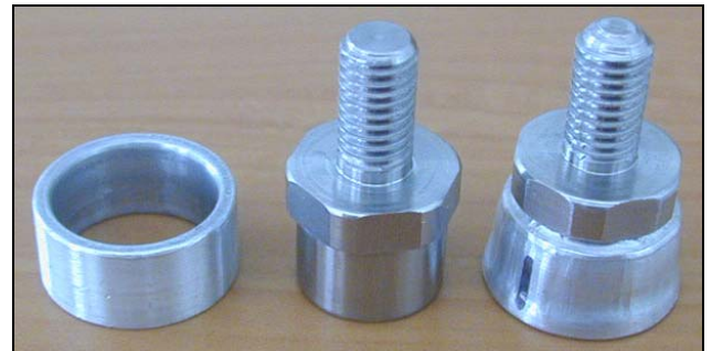
Figuur 9 : Magnetisch puls lassen van roestvast stalen bouten aan aluminium ring [5]
