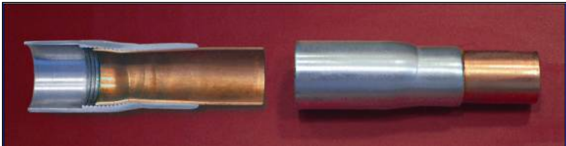
Figuur 7 : Lasverbinding van aluminium aan koperen buisjes [4]
