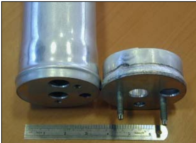
Figuur 8 : Magnetisch puls lassen versus MIG-lassen [4]
