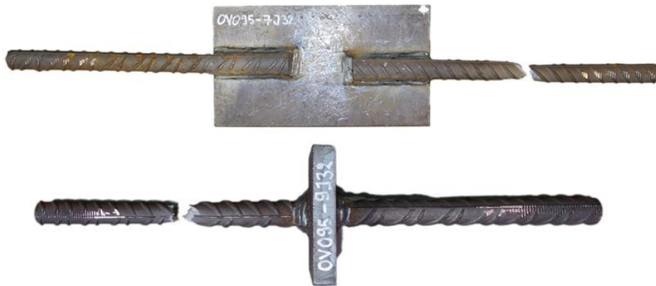
Twee types lasverbindingen na trekproef: lap joint (boven) en seton (onder)
