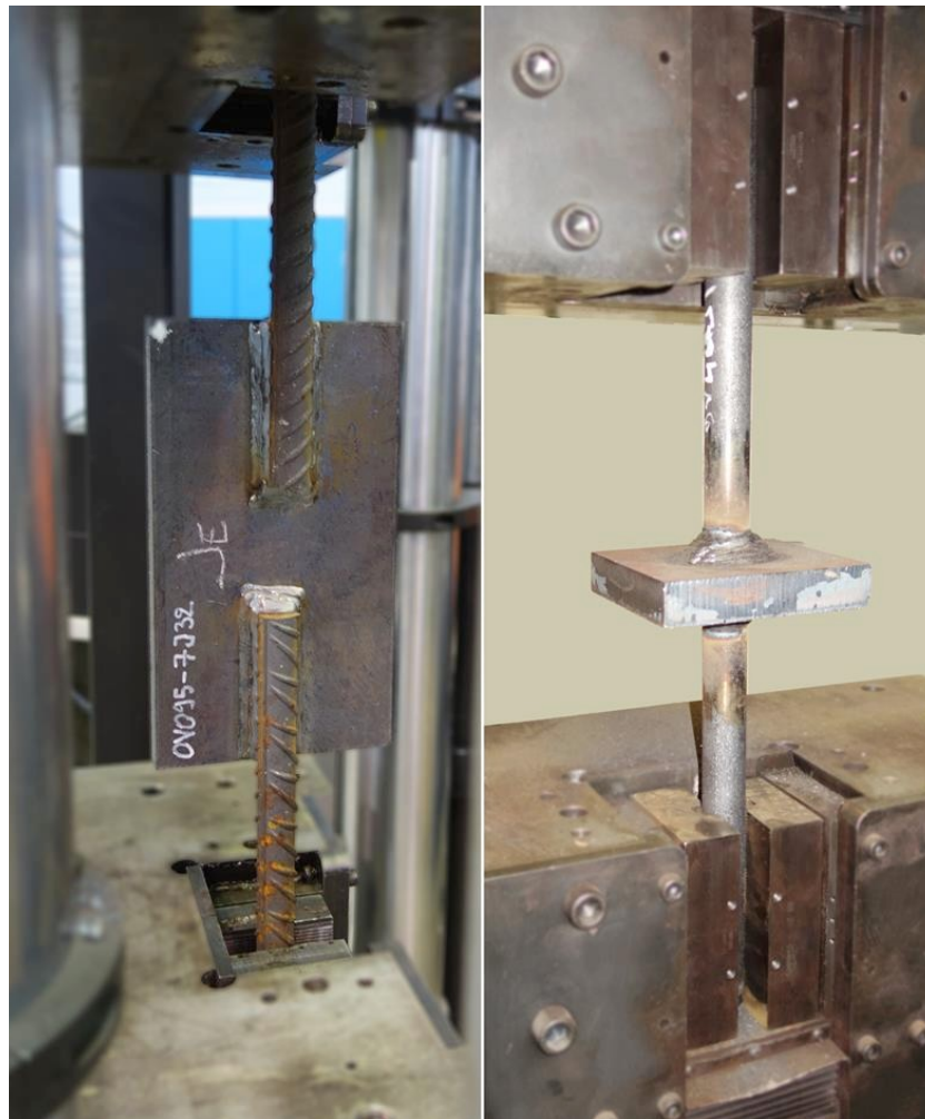
Respectievelijk side lap en seton verbinding in trekbank
