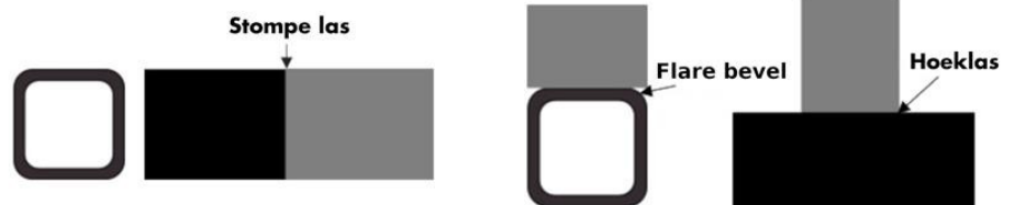
Figuur 1: Stompe opstelling (links) versus hoekopstelling (rechts)
